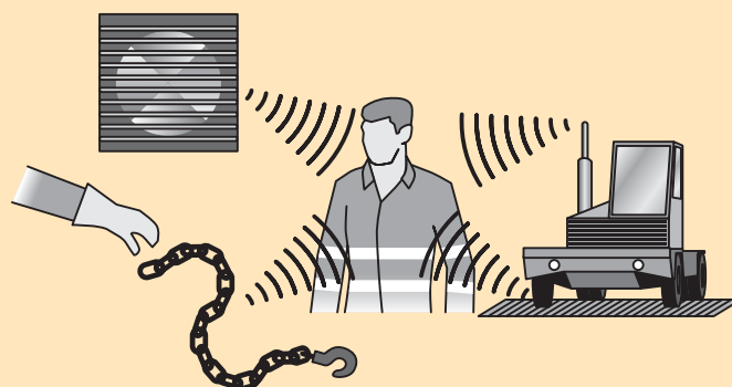
Figur 2: Fire kilder til støj: Ventilator, motor, surringsgrej og flaps.
